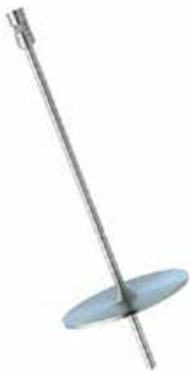
Figura 2: Husillo de disco para medir la viscosidad
